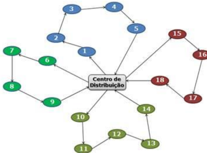
Figura 1 – Exemplo de roteamento de veículos a partir do centro de distribuição.
