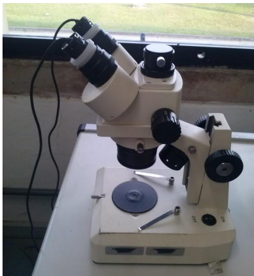
Figura 9: Webcams adaptadas para conexão nas oculares de um estereomicroscópio.
