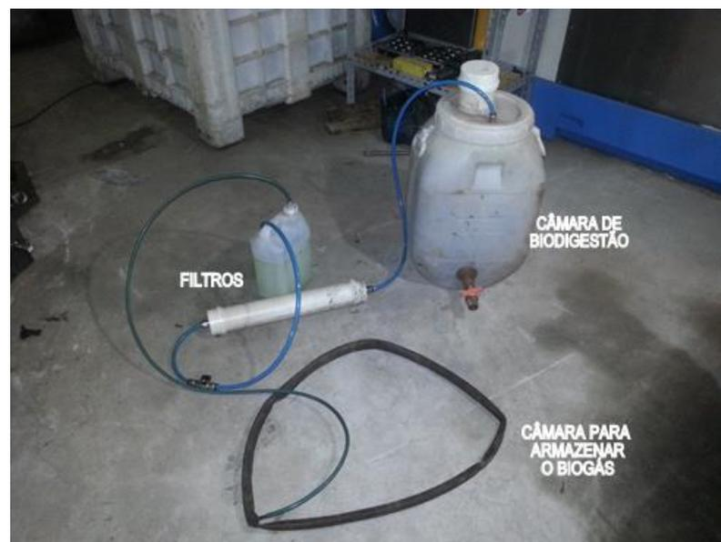
Figura 3 - Protótipo de biodigestor
