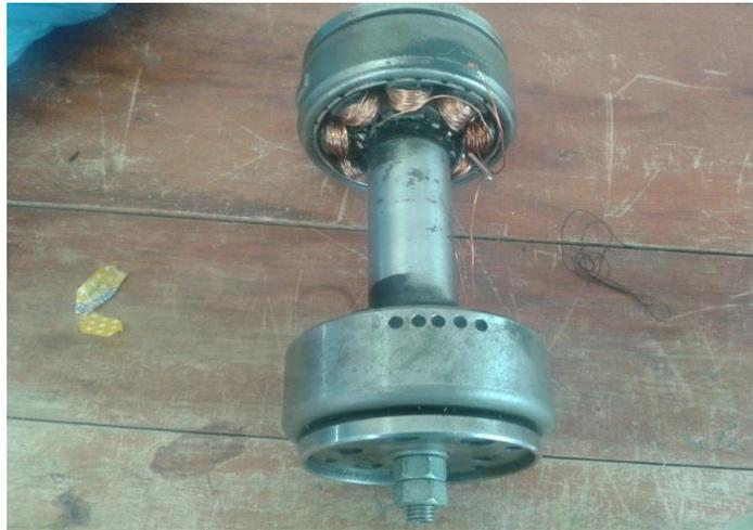
Figura 7 - Protótipo de um gerador elétrico
